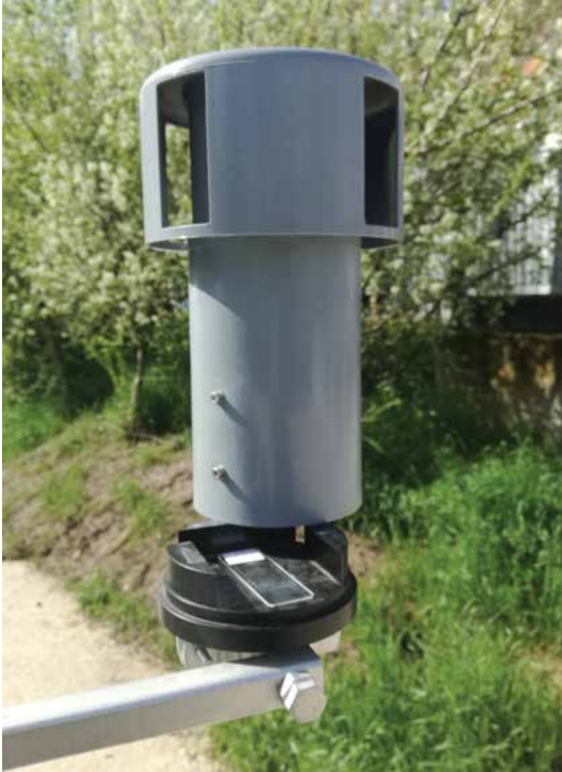
Figura 2. Campionatore passivo Sigma-2 ( passam ag ) con vetrino di campionamento
