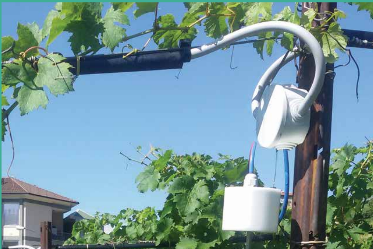
Dettaglio di un diffusore vibrazionale installato in un filare del vigneto sperimentale
