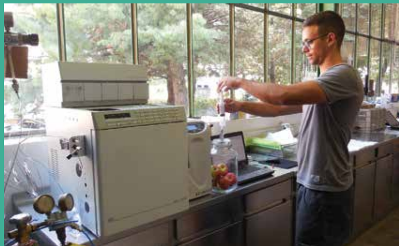
Fig. 2: Misurazione della produzione di etilene con gascromatografia dopo confinamento in vaso
