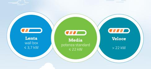
La velocità di ricarica dipende dalla potenza installata nella colonnina di ricarica e dalla capacità del sistema di accumulo installato nell'autovettura.
