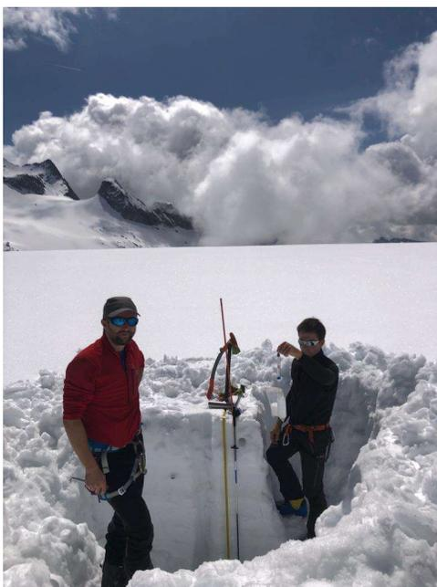
**Figura 4** – Misure di densità con dinamometro e cilindro carotatore (foto PAT Servizio prevenzione rischi e CUE)
