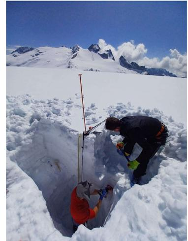
**Figura 2** - A sinistra scavo trincea per misure di densità manto nevoso. A destra scavo di profondità. (foto SAT E.Bertoni)
