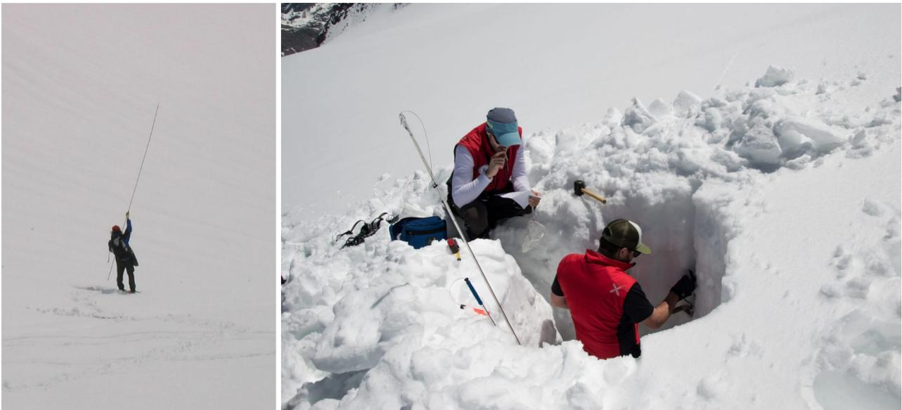
**Figura 2** - A sinistra sondaggio di spessore del manto nevoso mediante sonda da neve in carbonio (Foto L. Carturan). A destra misurazione della densità della neve in trincea sul ghiacciaio de La Mare (foto E. Valcanover).
