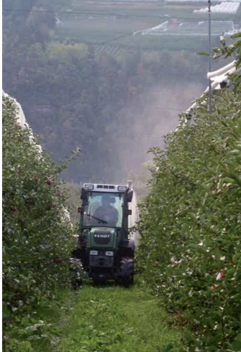
Impiego del dispositivo di esclusione laterale del flusso d'aria da un lato del convogliatore per orientare il trattamento solo verso il frutteto bersaglio.
